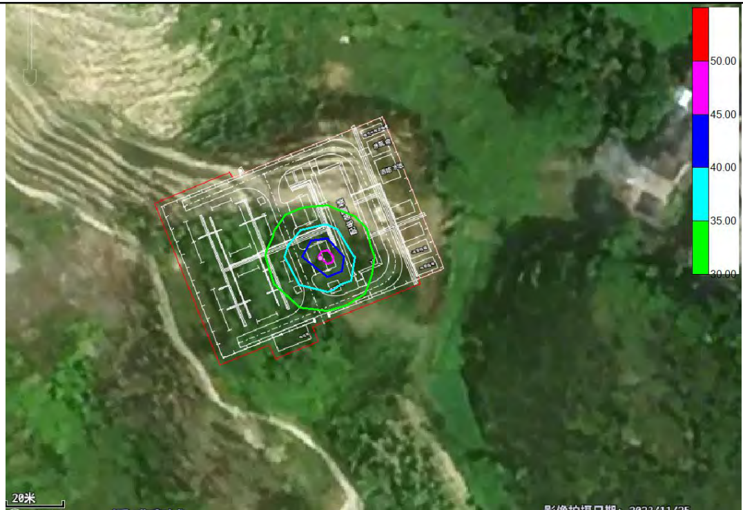
图 4-1 变电站噪声预测等声级线图
