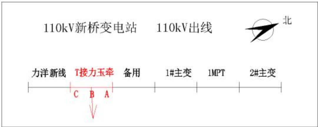
图2-1 新桥变电站110kV进线间隔排列示意图
