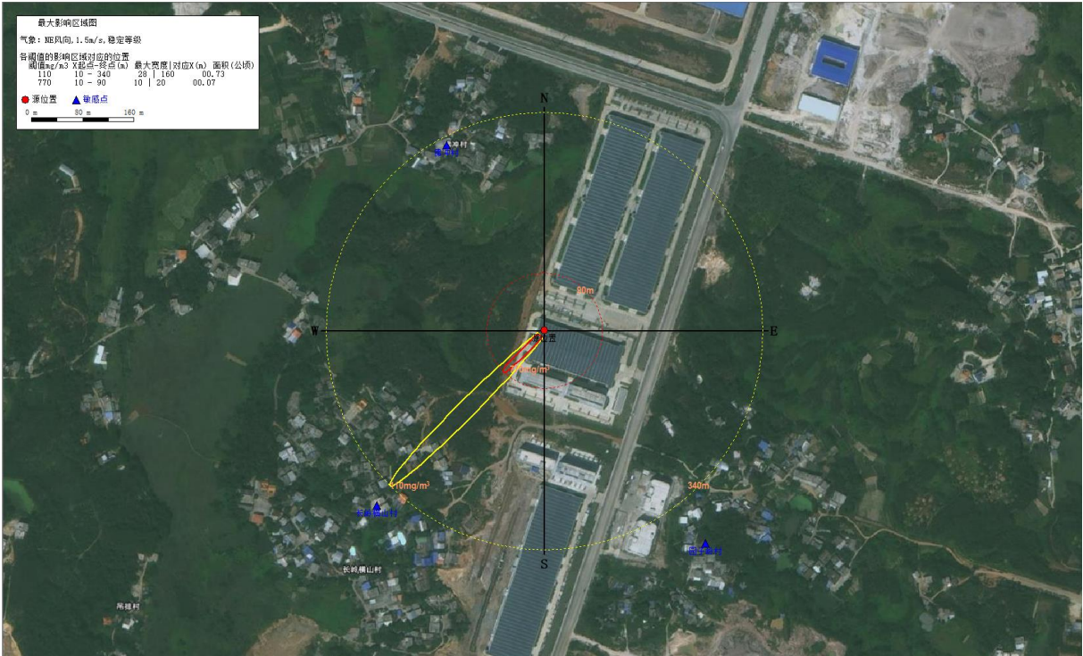
图6.1-2 氨水泄露最不利条件下超过阈值影响区域图
