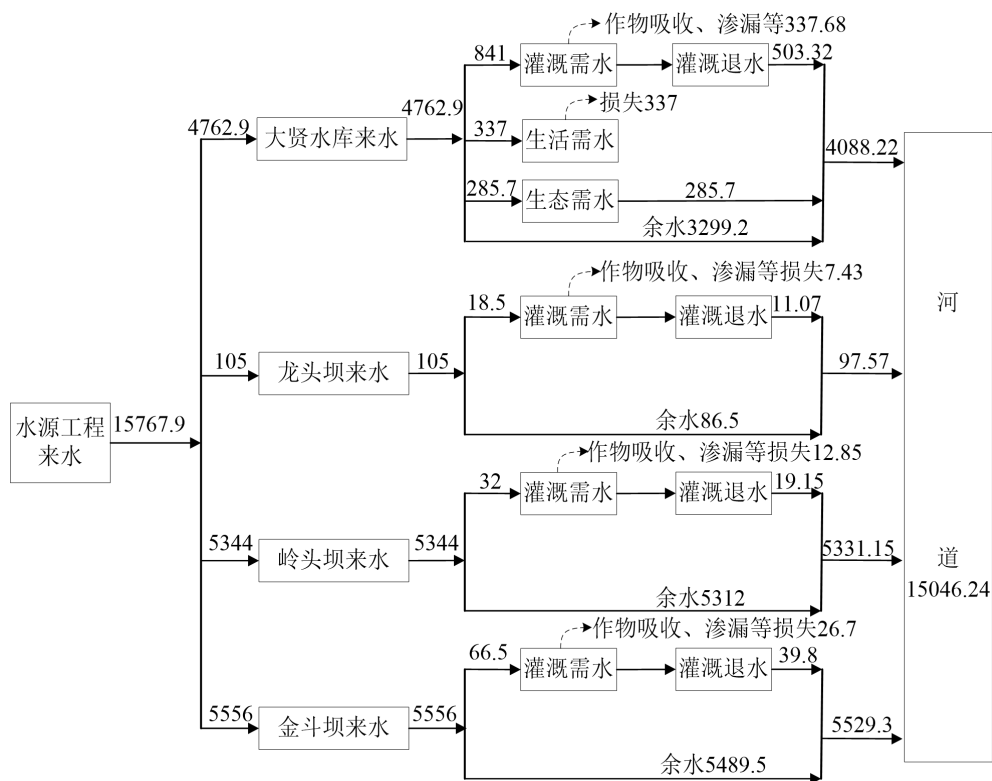
图2.3-16 改造后灌区15%保证率水平衡图 单位: 万m³/a
