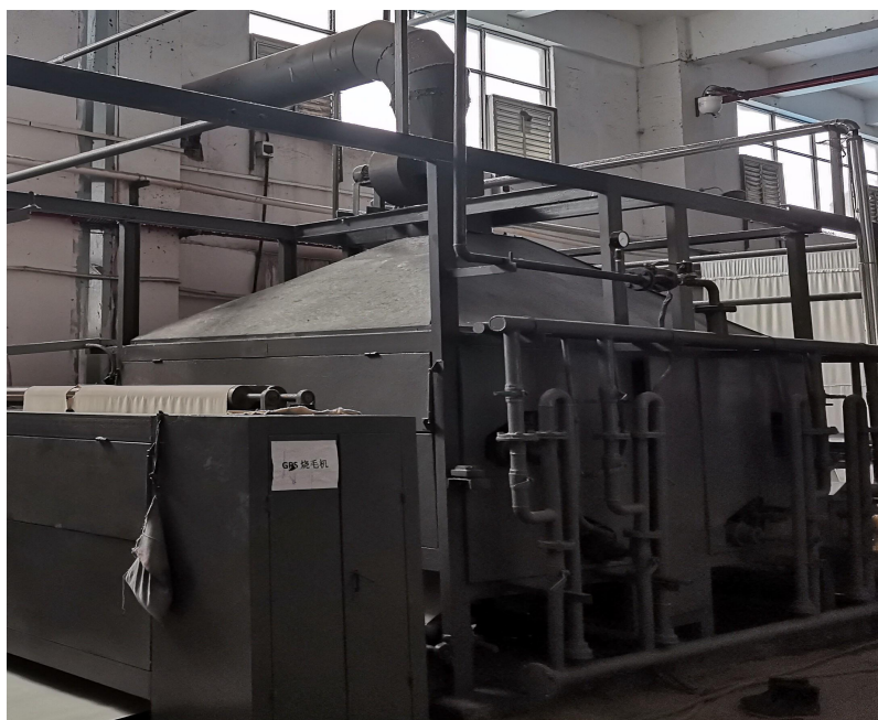
图 5-2 烧毛机实例图
