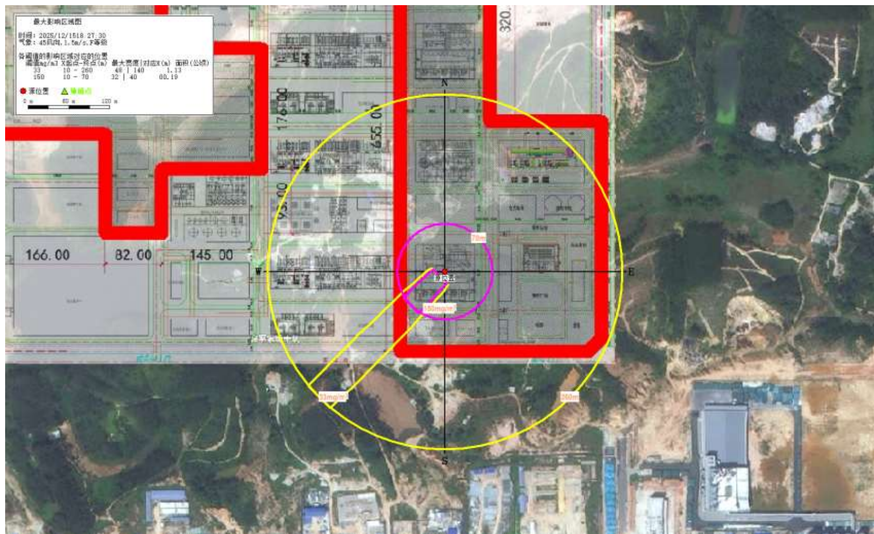
图5.5-3 烧碱生产装置区氯化氢泄漏的最大影响区域图（最不利气象条件下）
