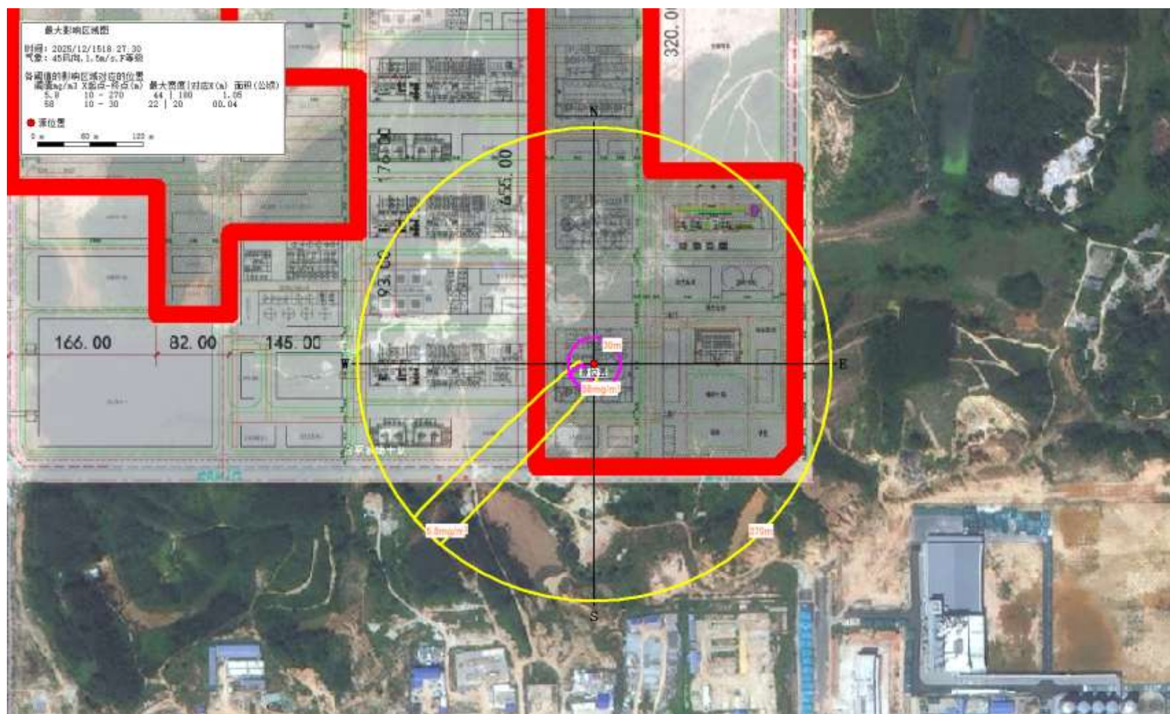
图5.5-1 烧碱生产装置区氯气泄漏的最大影响区域图（最不利气象条件下）
